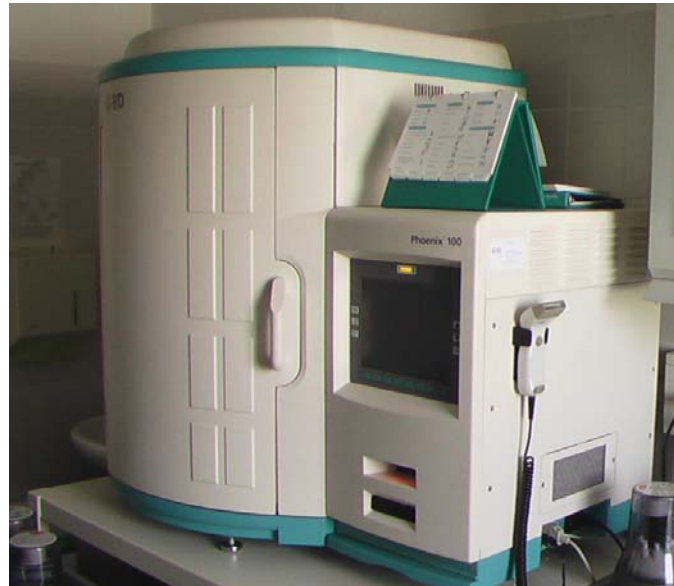
Abb.6: Automatische Identifizierung und Resistenzbestimmung mit dem Phoenix (
